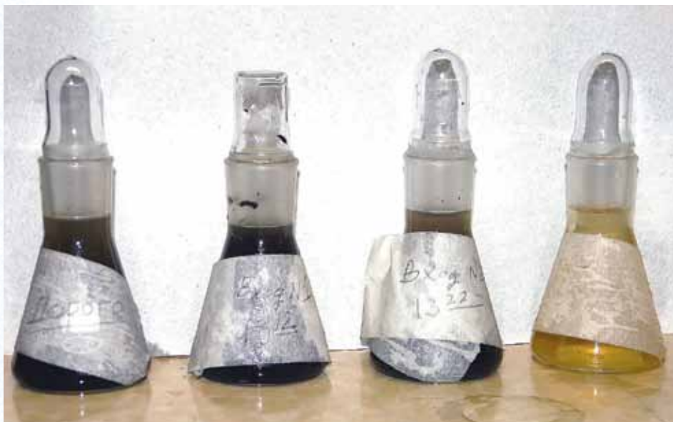
Рис. 1. Пробы дождевых сточных вод в лаборатории. Слева направо: с проезжей части, на входе № 1 в ГБП, на входе № 2 в ГБП, на выходе из ГБП после очистки
