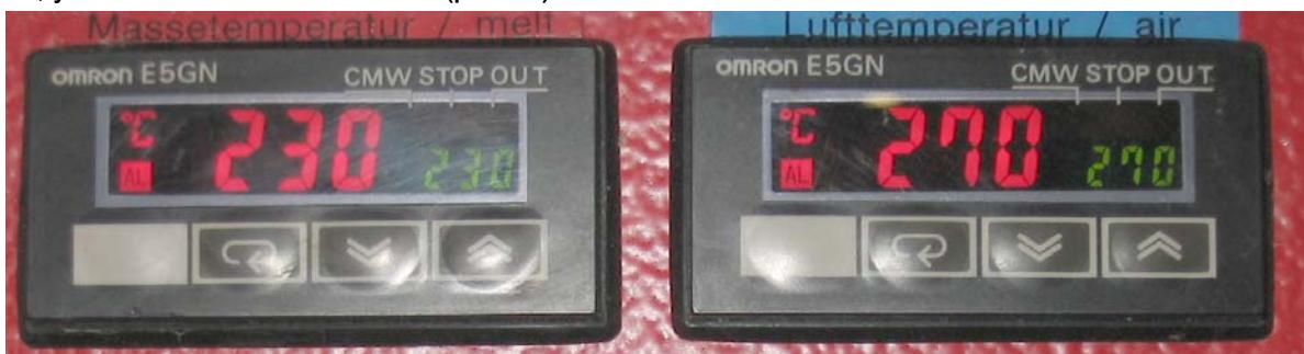
**Рис.11 Установка температуры присадочного материала и горячего воздуха на экструдере с раздельными контроллерами**
