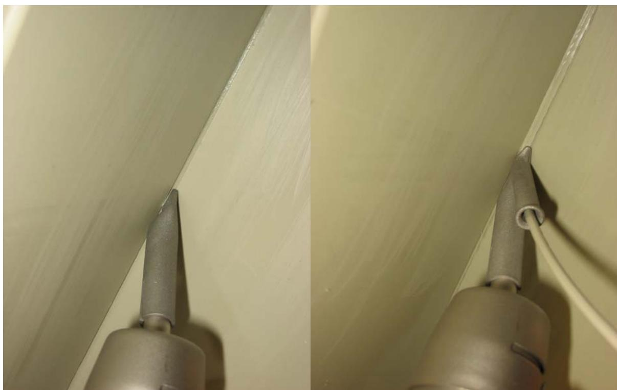
**Рис.9 Фиксация листов перед сваркой шва К-типа**
